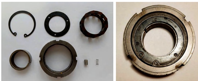
图7 基于保持架的偏心锁紧机构实物
