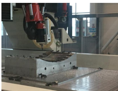
图5 五坐标加工中心铣切蒙皮过程
