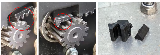
图6 储能过渡导向齿条完好情况及损坏情况
