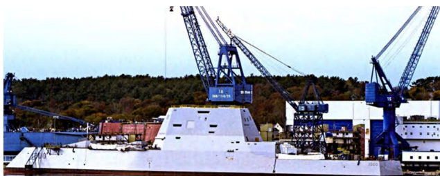
图3 采用模块化建造的大型舰船
