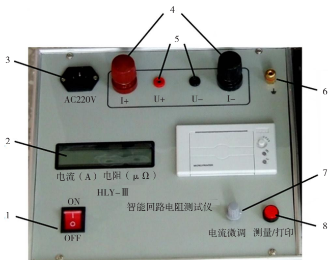
1.电源开关; 2.电流与电阻显示面板; 3.AC220V电源接口; 4.电流端接口; 5.电压端接口; 6.接地线; 7.电流调节按钮; 8.测量/打印按钮
