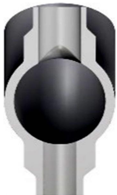
图7 打磨后截面效果示意
