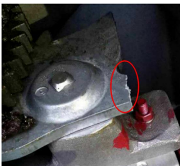
图2 辅助开关拨叉断裂
