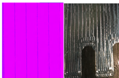
(a) 刀路沿 X 方向 (b) 实际加工结果
