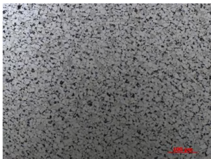
图2 200x 焊丝轧材金相组织
